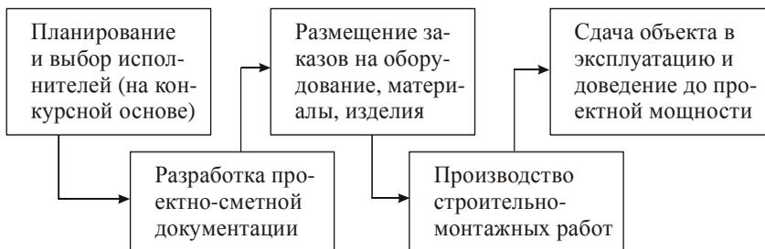
Рис. 3. Этапы создания строительной продукции
