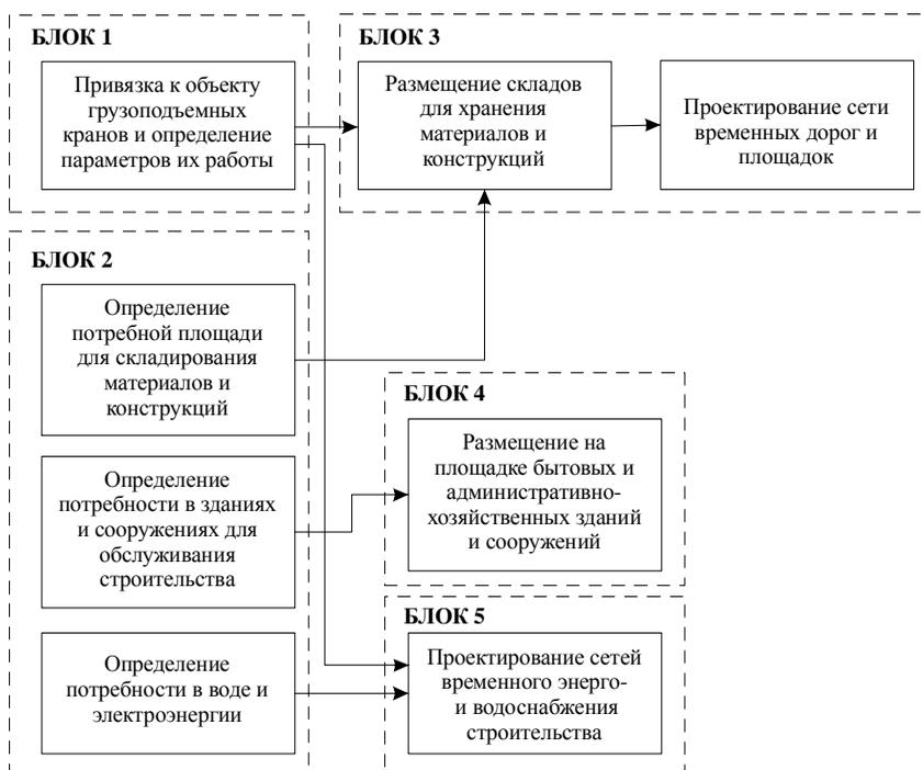
Рис. 26. Блок-схема разработки объектного стройгенплана
